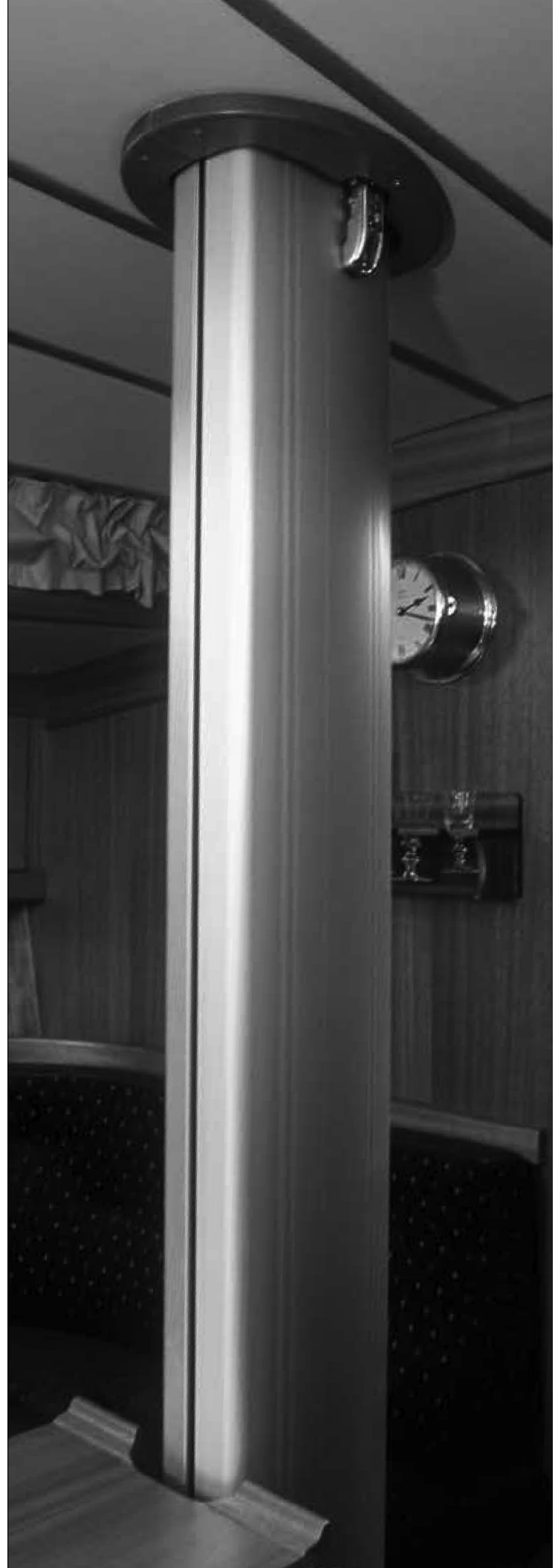
Anneau d'étambrai avec joint d'étanchéité moulé.
