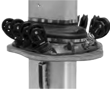
Anneau d'étambrai avec joint d'étanchéité moulé.
