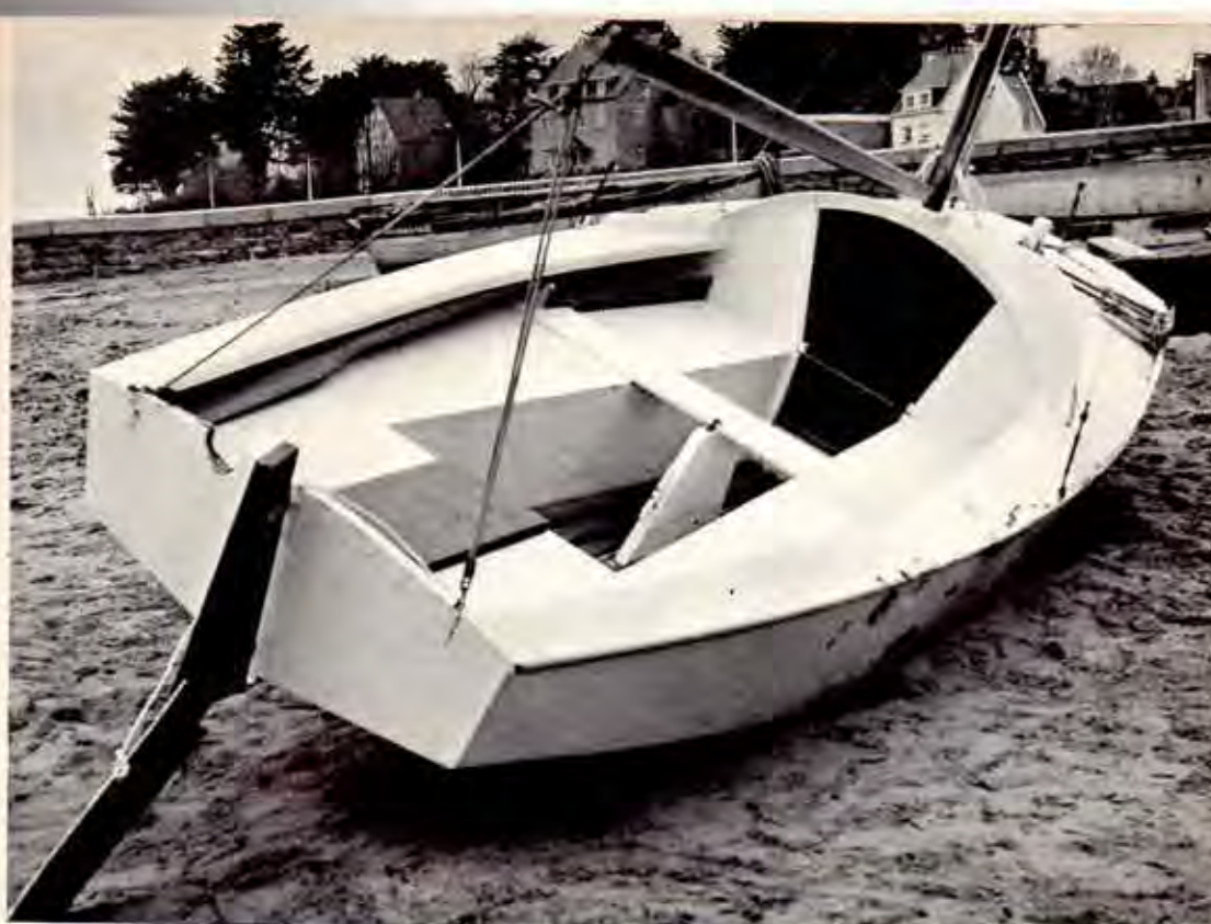
Disposition du cockpit de la Cigogne. L'aviron et la gaffe ont leur place sous les plats-bords. Pour deux jeunes l'avant peut être considéré comme une cabine.
