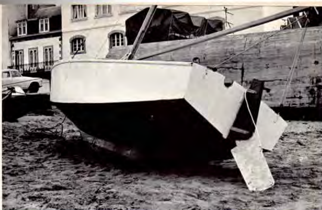
Le petit aileron porte-fest, placé sous la Cigogne, apporte une certaine stabilité, le rappel devenant moins important que sur la Caravelle.
