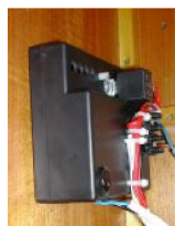
Convertisseur 12V-5V, avec relai et son interrupteur pour basculer en 12V forcé.
