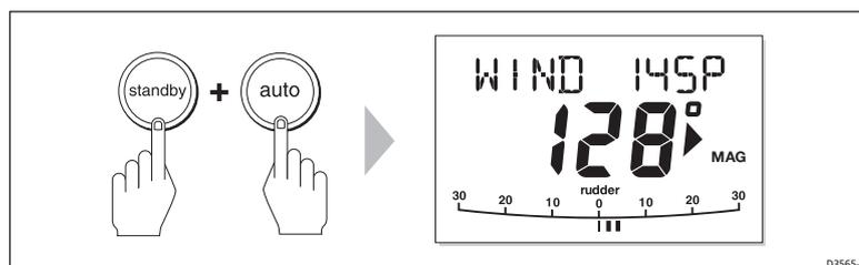
3. En mode Girouette, le SmartPilot ajuste le cap du bateau en permanence pour maintenir l'angle de vent programmé.
