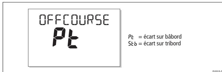
L'alarme d'écart de route (OFF COURSE) se déclenche si le cap en mémoire dans le pilote automatique et le cap que suit le bateau diffèrent pendant plus de 20 secondes. Elle indique si l'écart est sur bâbord ou tribord.
