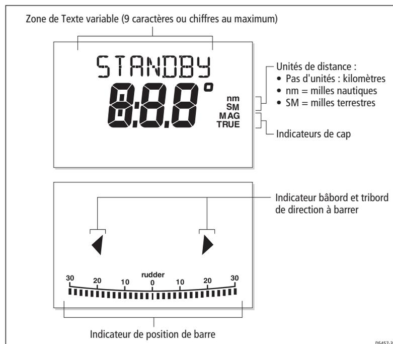
La graduation en bas de l'écran indique la position actuelle de la barre transmise par le capteur d'angle de barre.
