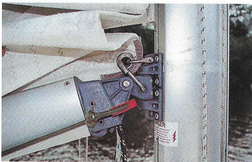
Une bôme et un vit-de-mulet qui inspirent confiance. Dommage que les rivets Pop ne soient pas à la hauteur.
