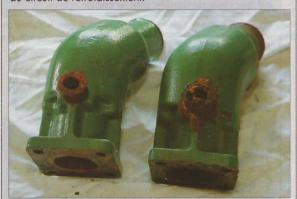
A gauche, la corrosion est superficielle et ne représente pas encore une menace, à droite, elle commence à obstruer l'arrivée d'eau. Danger !
