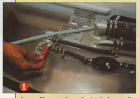
Avant d'intervenir sur le circuit de gasoil, on ferme la vanne située sur le réservoir. Cette vanne peut d'ailleurs s'encrasser et gêner elle-même l'alimentation.
