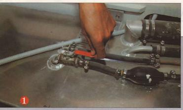
La vanne de gasoil doit être ouverte. La poire à carburant facilite l'amorçage, mais il est possible que le gasoil la détériore : il faut surveiller sa souplesse et son étanchéité.
