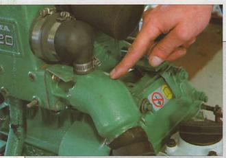
Le coude d'échappement reçoit l'eau de mer provenant de l'échangeur thermique et les gaz d'échappement venus des cylindres.
