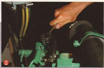
L'évent situé en haut de la pompe à gasoil est ouvert pour que l'air contenu dans le circuit puisse s'échapper. On le refermera quand on verra du gasoil sortir de l'évent.
