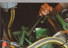
Pour amorcer le circuit haute pression, faire tourner le démarreur, injecteur ouvert, jusqu'à ce que le gasoil gicle.
