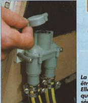
Après avoir nettoyé le filtre à eau de mer, il faut verser de l'eau pour réamorcer le circuit et éviter qu'il ne tourne à sec. Les pompes n'aiment pas travailler à vide!
