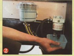
Avant de changer la cartouche du préfiltre, on vide la vasque du décanteur maintenue par un écrou. On vérifie au passage qu'elle ne contient pas d'eau.
