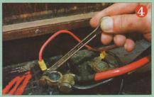
On remonte la cosse avec une clé de 10. Un serrage vigoureux évite les faux contacts et retarde l'oxydation.
