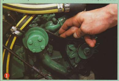
Sur une courroie bien réglée, la pression d'un doigt doit entraîner un environ un demi-centimètre de débattement. Au-delà, elle risque de rompre et en deçà, elle présente une résistance excessive.
