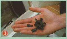
Les morceaux d'ailettes retrouvés doivent permettre de reconstituer entièrement la turbine. Un débris oublié peut obstruer le circuit.
