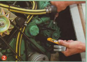
Après avoir desserré l'écrou de maintien situé audessus de l'alternateur on peut moduler la tension de la courroie en s'aidant éventuellement d'un manche pour faire levier.
