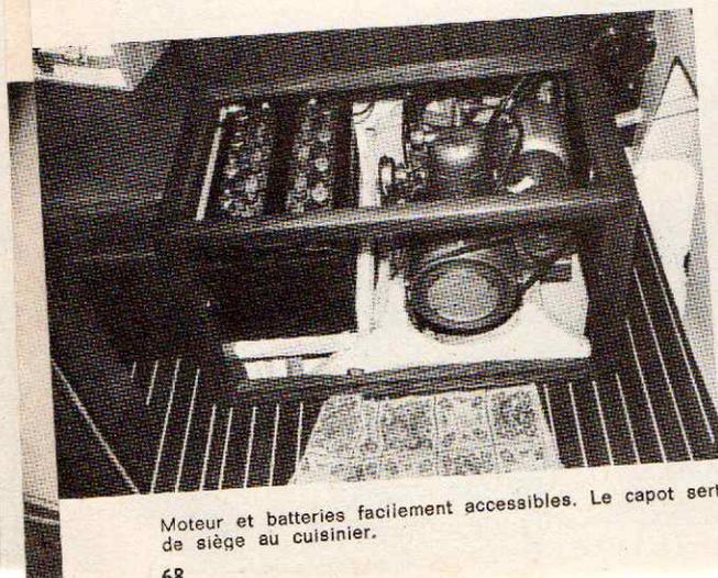
Moteur et batteries facilement accessibles. Le capot sert de siège au cuisinier.
