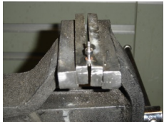
le deuxième est chassé mais il reste la partie contre l'axe, IL FAUT LE PINCER ET LE CASSER (très facile)
