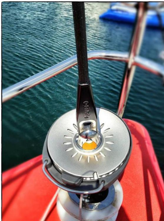
Ils peuvent se ressembler mais un câble pour un enroulement par le haut est fondamentalement différent d'un câble pour un enroulement par le bas que ce soit dans sa construction ou ses caractéristiques. Les câbles pour un enroulement par le haut sont plus chers et il peut s'avérer tentant de les remplacer par un câble standard, moins cher. Mais gardez en tête que vous le faites à vos risques et périls ... car une défaillance peut s'avérer couteuse!
