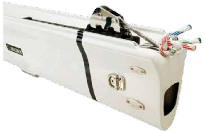
Extrémité arrière montrant le rail et le chariot de bordure, les réas dissimulés et le pad-eye de retenue de bôme.
