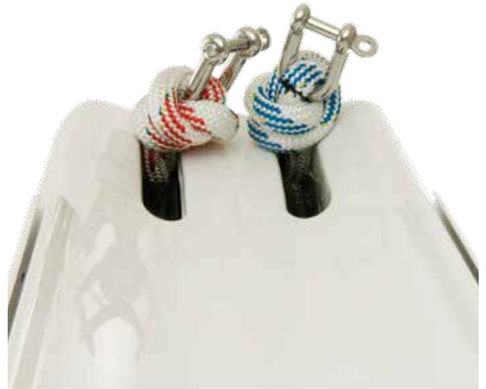
Détail des réas dissimulés dans l'embout de point d'amure.
