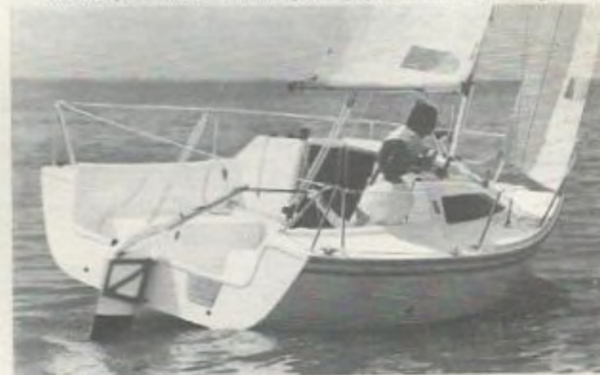
Dans le petit temps, mieux vaut dégager la large voûte du Microsail. On remarque le safran étroit et bien profilé qui peut coulisser dans sa cage.
