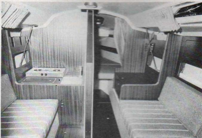
Réchaud un feu à cardan ou deux feux fixes pour la cuisine ; le puits de dérive est bien intégré dans l'agencement intérieur.
