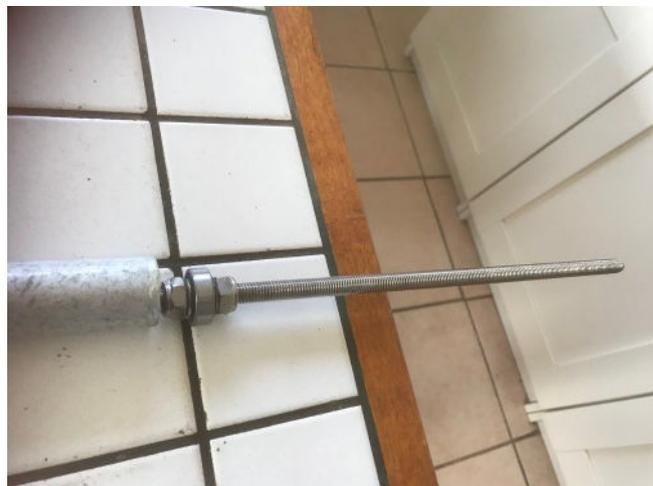
**Le matériel :** Une tige filetée de 10 mm d'1 m en inox, 2 roulements 10 mm intérieur, 27 mm extérieur, un tube aluminium de 27mm intérieur, 6 écrous frein inox, quelques rondelles inox. Une hélice, une visseuse dévisseuse.
