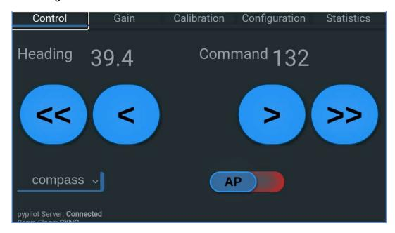
La page de contrôle est le principal contrôle web du pypilot. Le cap et la consigne sont affichés en haut, et lorsque le pilote n'est pas activé, les boutons  $\leq |$  >> sont affichés, et l'appui et le maintien de chaque bouton déplace manuellement le moteur. Si un capteur d'angle de barre est installé, un bouton supplémentaire s'affiche et peut être utilisé pour centrer la barre.
