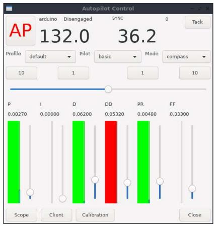
Le script pypilot\_control est le script principal donnant le contrôle, l'état et les gains d'ajustement. Vous pouvez choisir le profil utilisé, l'algorithme du pilote et son mode (compas
