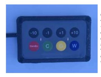
Ce clavier radio s'alimente aussi entre 9 et 40 volts et fournit les touches standard -10 -1 +1 +10. Plutôt que d'engager/désengager le pilote, il dispose d'une touche permettant de toujours désengager le pilote. Les boutons C, G, W activent le pilote dans les modes Compas, GPS et Vent. Appuyer simultanément sur C et G permet d'accéder au mode Nav, et sur G et W en même temps pour accéder au mode Vent réel.
