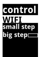
• **control** - Ajuster les paramètres wifi, et les sauts pour les boutons - et +. Si les paramètres wifi sont changés, et que vous ne pouvez pas vous connecter, il est possible de revenir en mode AP en utilisant ce menu pour se reconnecter au pilote.
