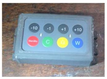
Ce clavier radio a des fonctions identiques au précédent à 8 boutons, mais il est alimenté électriquement avec 2 piles AA pour simplifier son installation. Le courant de veille est de 4 à 6 µA, donc les piles devraient généralement durer plusieurs années. Il est cependant recommandé de n'utiliser que des piles alcalines et de les remplacer tous les deux ans pour éviter qu'elles se mettent à couler.
