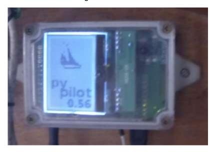
Après alimentation électrique, l'écran de démarrage est affiché 10 à 15 secondes après la mise sous tension. L'écran indique la version du pypilot et peut être utile pour le débogage du système.
