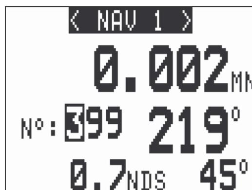
La position de l'évènement est mémorisée dans le point de route N° 399. Au relâchement la fonction <NAV1> s'affiche pour indiquer la distance et l'azimut de la position de l'incident. A chaque nouvel appui sur la touche **MOB**, le point précédent (enregistré dans le N° 399) glisse au point de route N° 398 et chaque nouvelle pression sur la touche **MOB** décale le rang jusqu'au numéro butoir 390. Lorsque les 10 points instantanés **MOB** sont utilisés, un nouvel appui sur la
