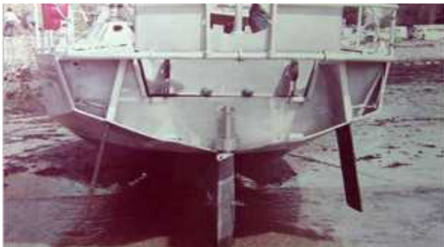
Dérives arrières et Safran relevable sur le DALITE, plans de JF ANDRE
