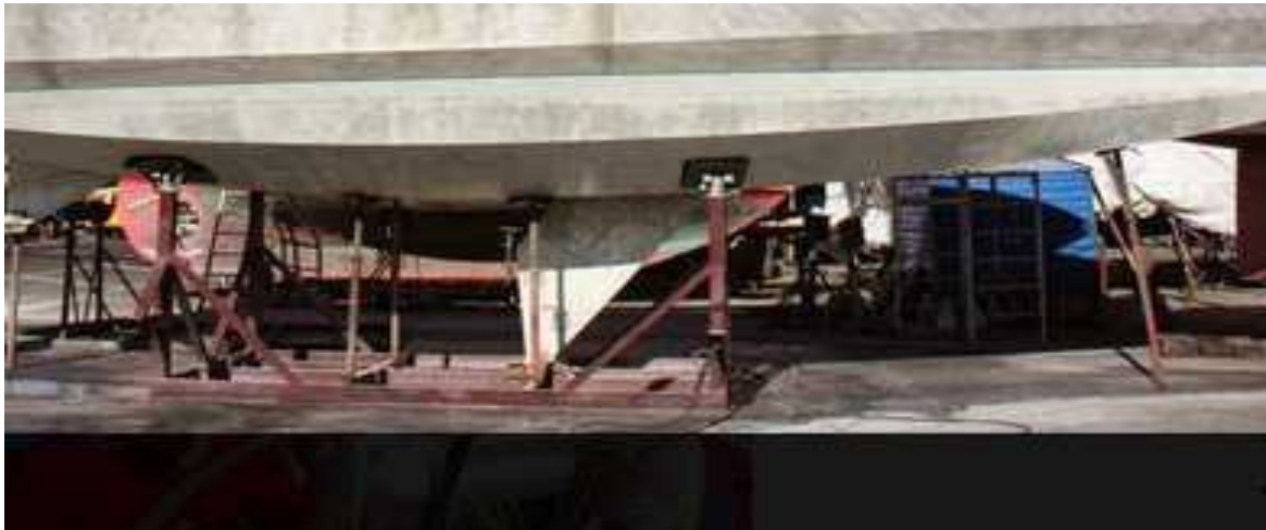
Dérive réalisée dans une simple tôle. Surface probablement insuffisante pour le près.
