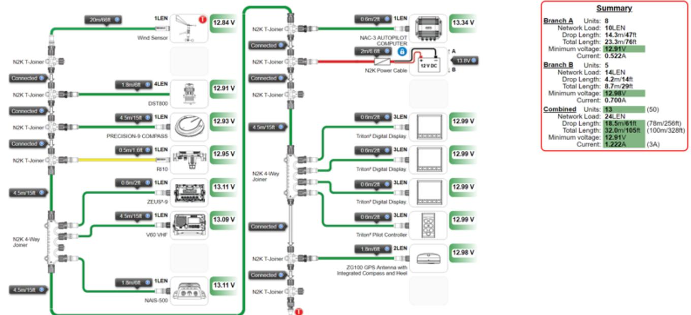
La dernière étape consiste à connecter l'alimentation à votre point d'insertion d'alimentation. Cela devrait être une alimentation de 12 V DC. Dans la pratique, à bord de votre navire, il est probablement 13,8 V DC. La puissance de fusible correcte pour l'alimentation est d'utiliser un fusible à soufflage lent de 5A, alimenté par votre panneau de commutation. Les spécifications pour l'alimentation d'un réseau NMEA2000 sont les suivantes :
