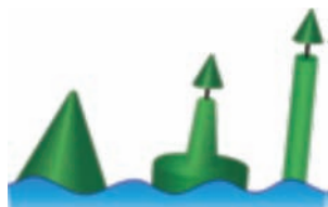
Marques tribord : voyant conique, couleur verte, feu vert, rythme quelconque. À laisser à tribord en venant du large.
