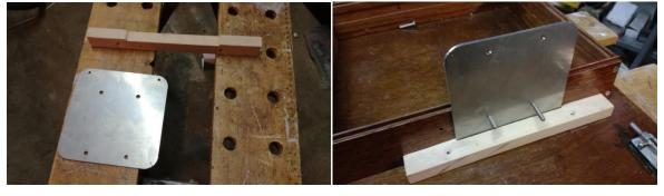
La plaque de 2 mm d'épaisseur est boulonnée au support WC par deux boulons de 6 mm. Un tasseau de renfort empêche la plaque d'osciller latéralement. Le fond du support est du CTBX de 15mm et les parois sont des chutes de parquet massif.
