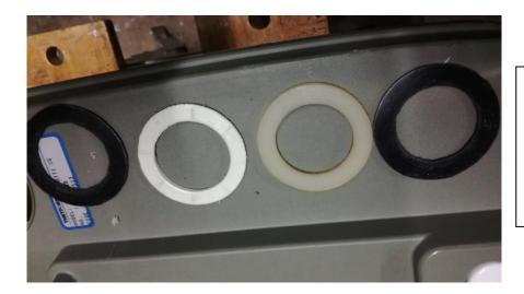
Confection de rondelles de renfort et joints pour fixer le tube plongeur qui va aspirer le fond du réservoir. Tout est fait à la main dans du matériau de récup'.
