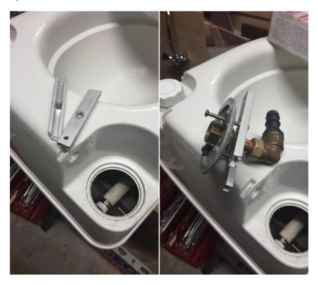
A gauche, les morceaux de rails sont équipés d'un écrou riveté chacun. Les écrous rivetés se posent soit à la pince à rivet pop munie d'un embout spécifique, soit avec une vis, une rondelle et un écrou pour serrer et évaser la tête de l'écrou. Lorsque la vis est retirée, l'écrou est serti sur le rail en alliage léger.
