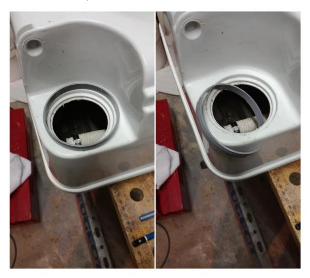
Il a bien sûr fallu le couper pour le faire entrer et positionner sous l'ouverture circulaire. Un peu de colle PVC et l'ouverture se trouve rigidifiée. Idéalement, un bouchon taraudé au bon diamètre aurait commodément trouvé sa place ici, mais je n'en avais pas sous la main. Cela aurait simplifié l'étape suivante. Autre idée possible : réaliser un anneau plat et pourvu de 5 ou 6 taraudages, introduit de la même façon et servant de contreplaque.
