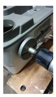
Perçage à la scie cloche de la face arrière pour installer un raccord à angle droit.
