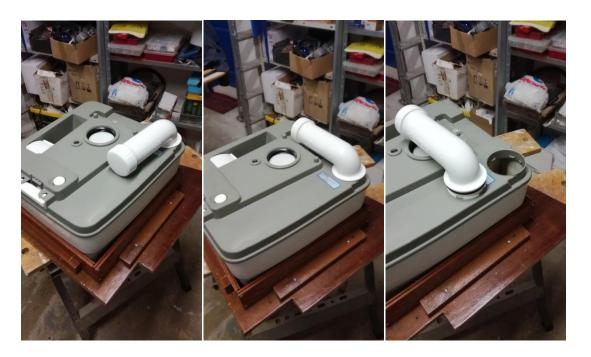
En tournant le bras de vidange de 270 degrés en sens anti-horaire, on peut retirer le tuyau de vidange pour avoir accès à l'intérieur du réservoir de matières. Il y a deux possibilités pour placer le tuyau d'aspiration de la pompe broyeuse : à l'arrière ou bien dessous. Sur mon bateau, c'était plus facile de choisir la première option.
