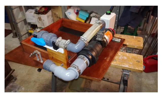
La vanne d'arrêt est maintenue à la bonne hauteur par une plaque en bois. Après essai, elle interférait avec le WC. En effet, il ne suffit pas qu'il y ait de l'espace, il faut prévoir que le WC se déforme légèrement sous le poids de son utilisateur. La plaque en bois a donc été coupée pour ajouter ceci :
