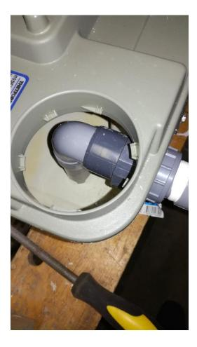
Le montage du tube plongeur se fait par serrage des raccords. Les tubes et raccords sont du standard trouvé chez un vendeur de tubes et raccords en PVC.
