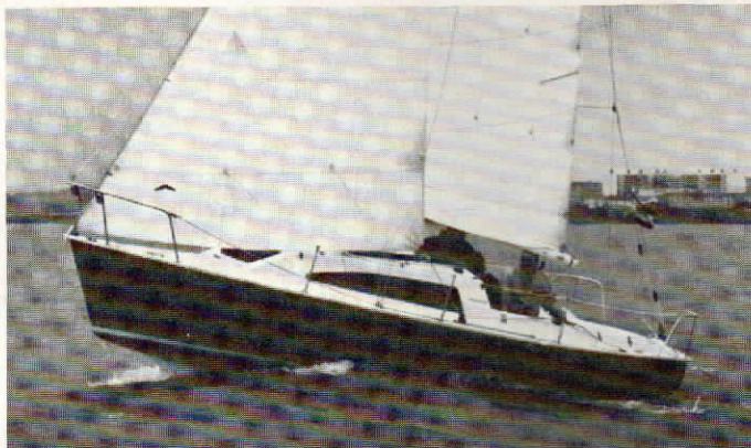
Dans un clapot sans vent, l'étrave soulage sans que la coque se freine.
